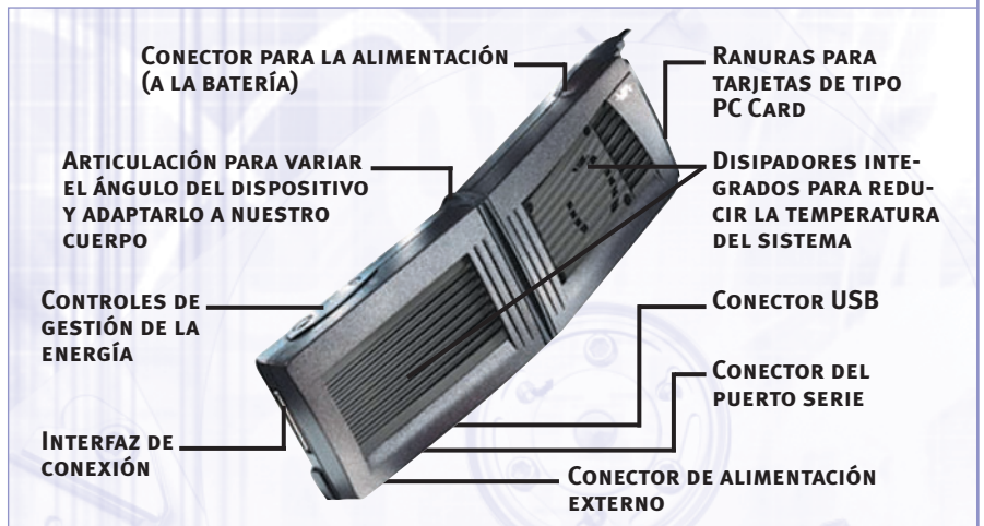
Los principales elementos del Poma: la unidad central, el dispositivo apuntador óptico y la pantalla LCD.
